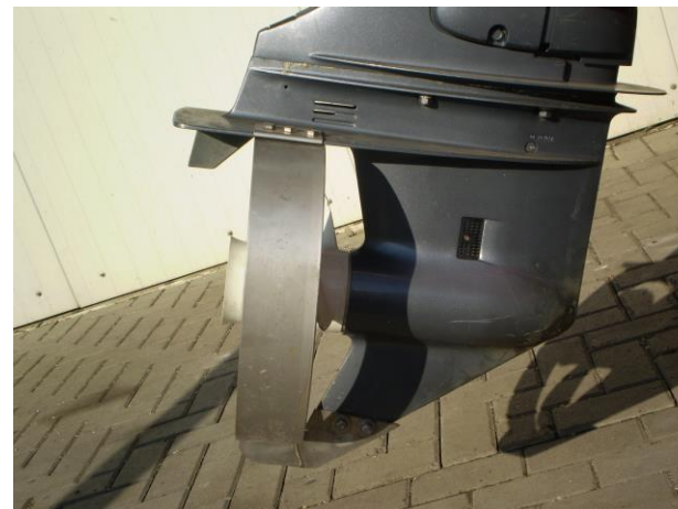
Propellerschutzring (zwingend erforderlich bei Rettungsbooten)
