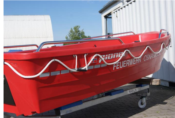
Äußere Griff- u. Haltleine (zwingend erforderlich bei Rettungsbooten)
