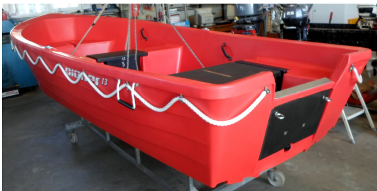
Hebegeschirr und äußere Griff- u. Haltleine (zwingend erforderlich bei Rettungsbooten)
