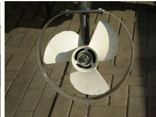
Propellerschutzring (zwingend erforderlich bei Rettungsbooten)
