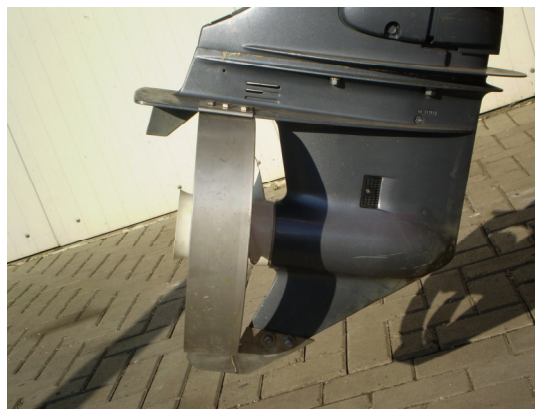
Propellerschutzring (zwingend erforderlich bei Rettungsbooten)
