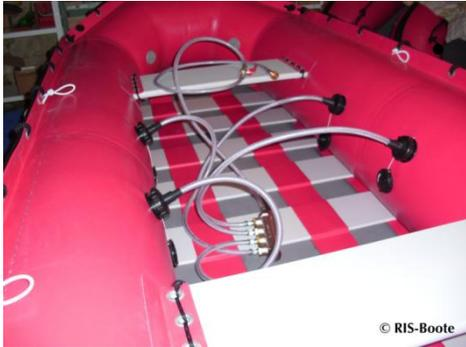
Abb. 9: Vier voneinander unabhängige Luftkammern
