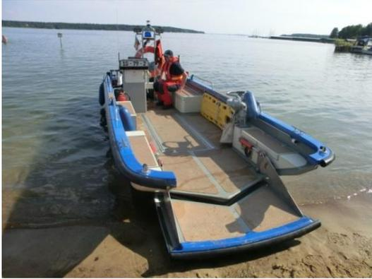
Abb. 18: Boot mit Bugklappe
