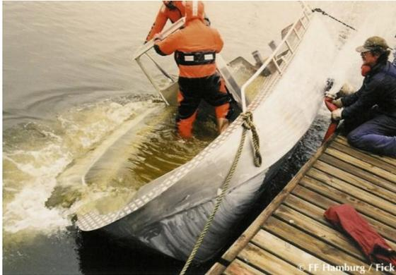
Abb. 12: Kenterversuch mit einem Neubau
