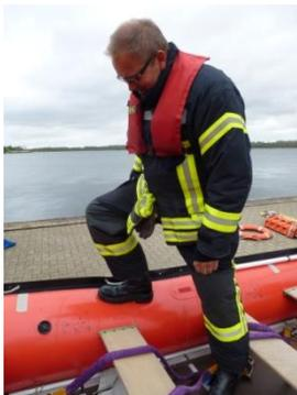
Abb. 10: Formbeständigkeit des Bootes bei Belastung
